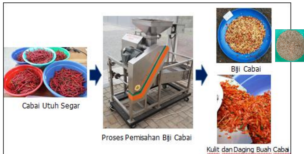
Gambar 5. Proses pengujian mesin pemisah biji cabai
