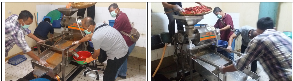
Gambar 6. Proses pengujian mesin pemisah biji cabai
