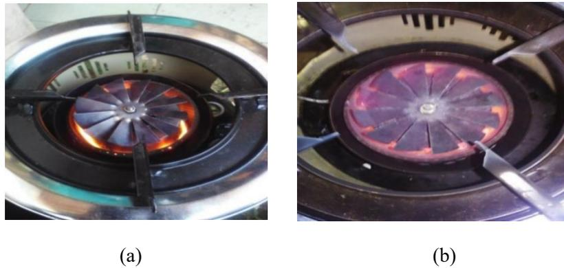
Gambar 11. Perbandingan warna api pada kompor sebelum modifikasi (a) dan setelah modifikasi (b)
