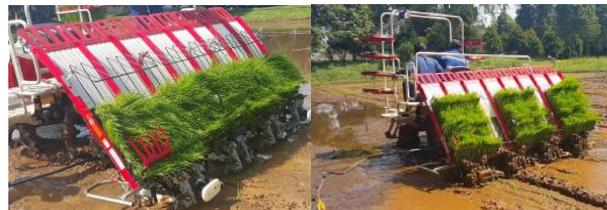
Gambar 4. Pengujian mesin dengan jarak tanam sistem tegel (kiri) dan Jarwo 2-1 (kanan) di lahan A
