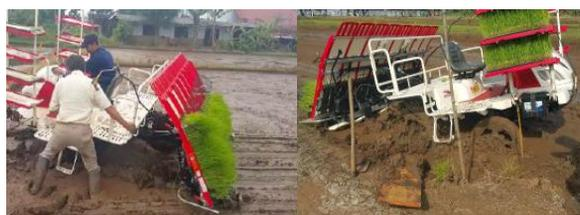
Gambar 6. Mesin tenggelam pada saat jalan berbelok
