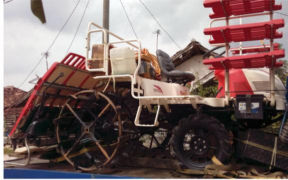
Gambar 7. Penggunaan roda besi delapan sirip
