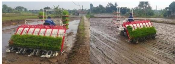
Gambar 5. Mesin berjalan baik pada pengoperasian jalan lurus
