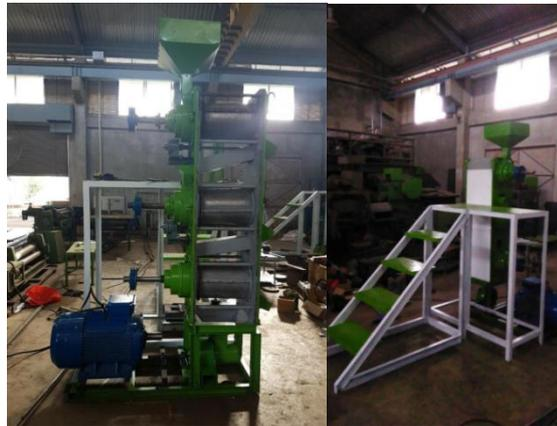
Gambar 5 Mesin penyosoh sorgum tipe silinder tiga tingkat
