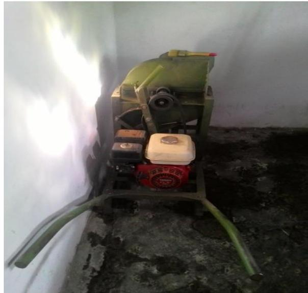
Gambar 9 : Alat pencacah pelepah
