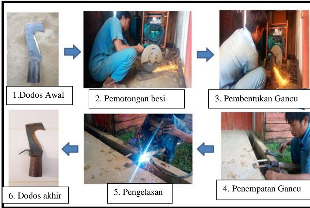
Gambar4. Proses pemasangan gancu
