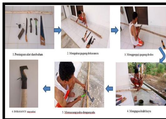
Gambar 5. Proses pemasangan Dokasancu
