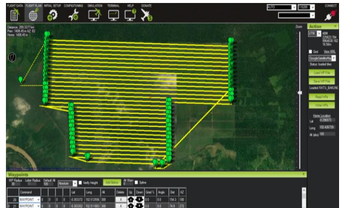
Gambar 3. persiapan pemotretan dan pembuatan jalur terbang menggunakan mission planner.
